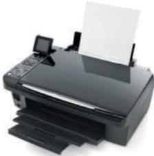
الطابعات (Printers) تستخدم لطباعة نتائج معالجة البيانات على الورق كمستندات أو كصور مثلاً. تتم الطباعة باستخدام الطابعات النافثة للحبر التي تستخدم الحبر السائل، أو طابعات الليزر التي تستخدم الحبر الجاف كما هو الحال بالنسبة لآلات تصوير المستندات.
